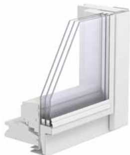
Nízkoenergetické trojsklo 65 U_{\text{okna}} = 1,0
